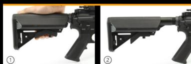
Pro upravení délky pažby stlačte pojistku vysouvání pažby (obr. 1). Pojistku držte stlačenou a tahem nastavte požadovanou délku pažby - pažba má šest aretačních poloh. Po vysunutí pažby na požadovanou délku uvolněte pojistku vysouvání pažby (obr. 2). Správné zajištění poznáte podle slyšitelného "cvaknutí" aretačního kolíku.
